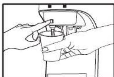
12. Установите на место крышку бака холодной воды в сборе. Откройте кран подачи воды в водораздатчик. Проверьте подачу воды из крана холодной воды. Если вода не течёт, нажмите, пожалуйста, кнопку для стравливания воздуха из бака холодной воды. Проверьте подачу воды из крана горячей воды. Вода должна идти непрерывной струёй.
