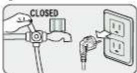
2. Сливайте горячую воду через краник горячей воды до тех пор, пока не опустится температура воды до уровня комнатной.
